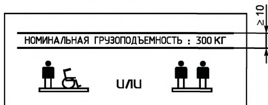
Рисунок 8 — Пример таблички с информацией о грузоподъемности
